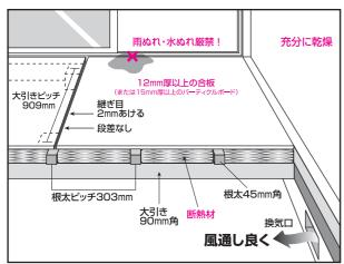
1. よく乾燥して、風通しがよいこと。 建築基準法施工令:外壁の床下部分に長さ5m以下ごと に300cm以上の換気口の設置。 床下の通風が悪く、湿度が高くなると床材の反り、突
